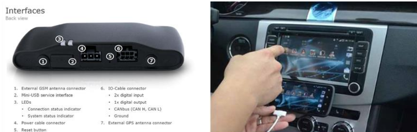
Figura 6. Ejemplo de equipo de abordaje e integración en vehículo y “smartphone”. Fuente: TomTom Telematic.
